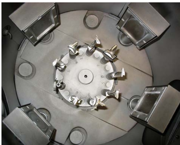
Рис. 1. Схема квадрупольной НМРС в установке QUADRA 400Lab.
